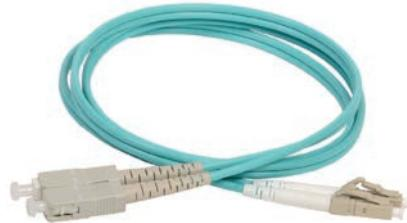
Для патч-кордов этой серии используется волокно, которое поддерживает передачу данных со скоростью 10 Гб/с на расстоянии до 550м (многомодовое волокно 50/125 OM3), оконцованные разными видами разъемов.
