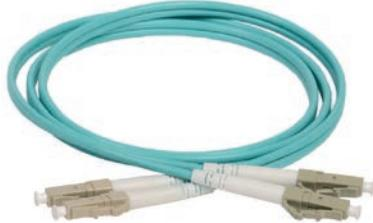
Для патч-кордов этой серии используется волокно, которое поддерживает передачу данных со скоростью 10 Гб/с на расстоянии до 550 м (многомодовое волокно 50/125 OM3), оконцованные с двух сторон одинаковым видом разъемов.
