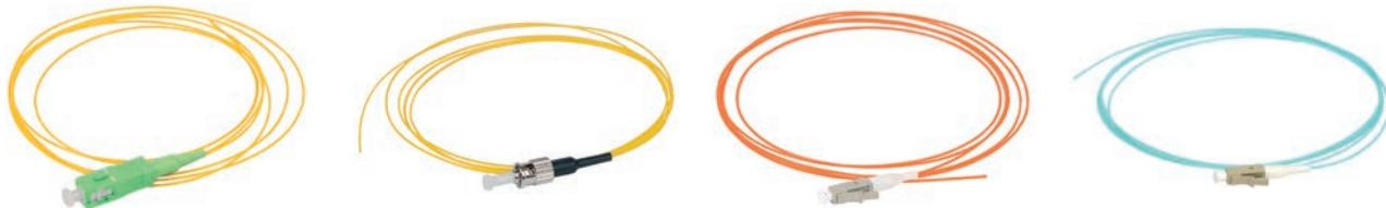
Оптические монтажные шнуры или по-другому пигтейлы (в простонародье – поросьячий хвостик) представляет собой отрезок кабеля, оконцованный с одной стороны разъемом, второй конец соединяется с волокном с помощью сварки. Длина наших пигтейлов составляет 1,5м. Существуют также одномодовые и многомодовые пигтейлы, одномодовые имеют внешнюю оболочку желтого цвета, многомодовые – оранжевого.
